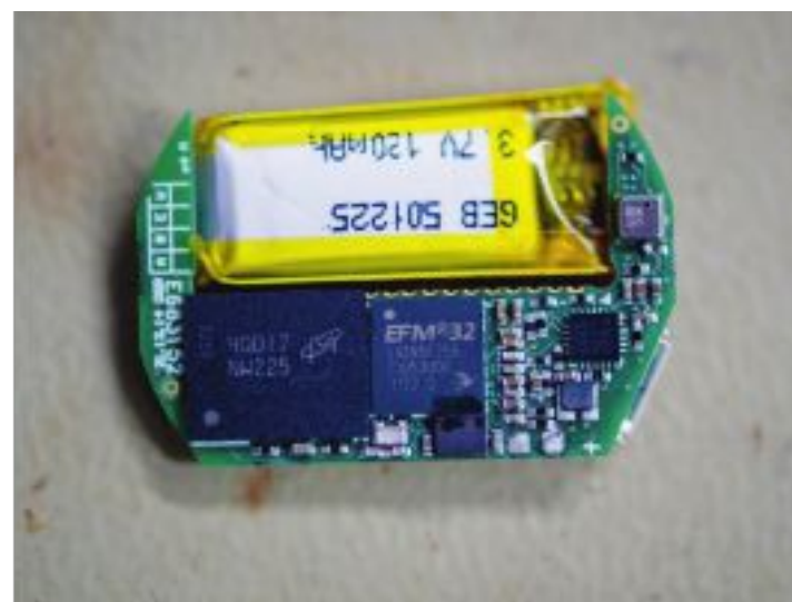
Das Herzstück: Der Axiamate-Sensor misst Beschleunigung, Rotation, Erdmagnetfeld und den Luftdruck.
